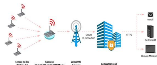
Fig.2 LoRa WAN schema
